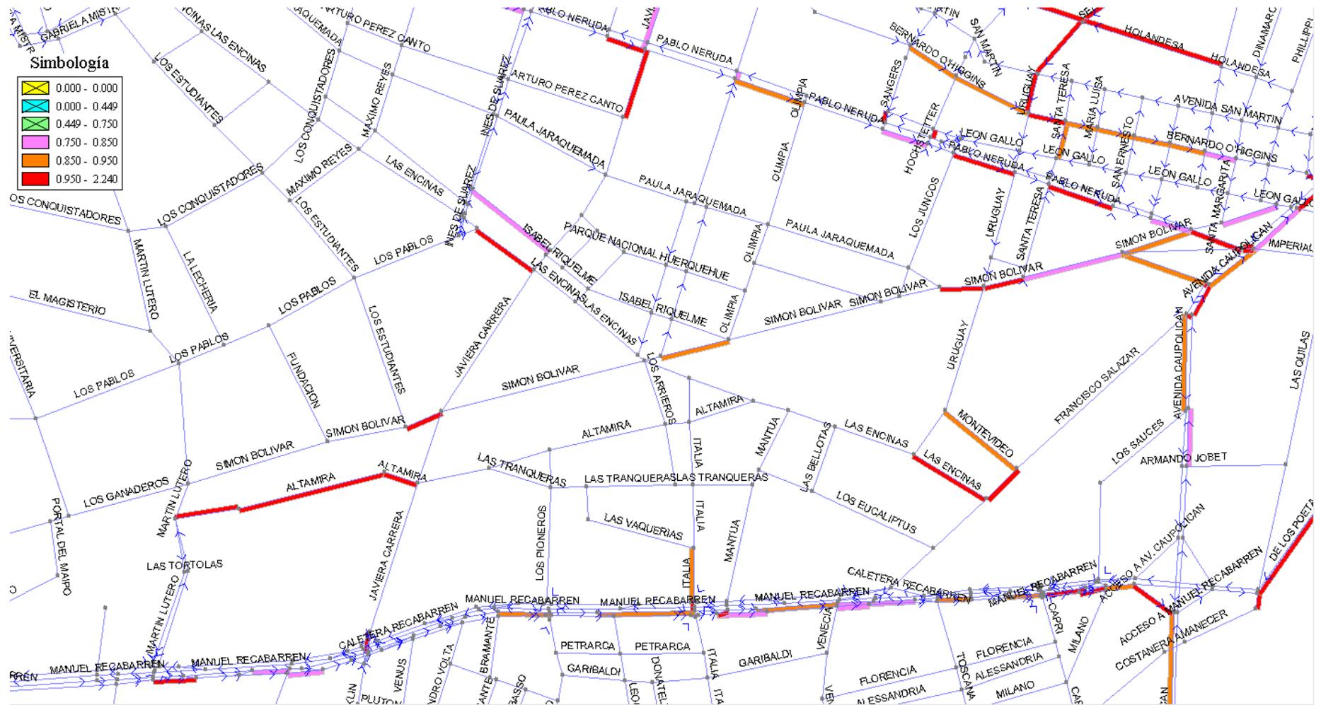
Figura N° 114: Arcos con Grado de Saturación Alto Punta Mañana PRC– Situación PRC Sector Poniente Sur
