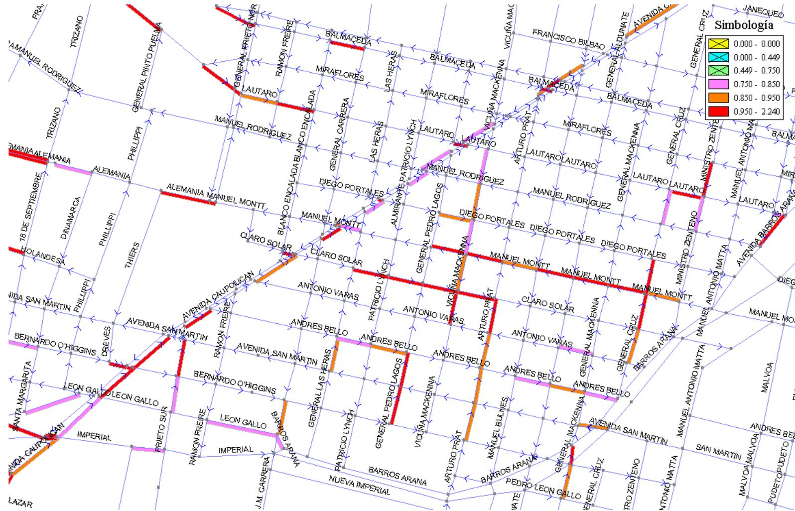
Figura N° 112: Arcos con Grado de Saturación Alto Punta Mañana PRC- Situación PRC Sector Céntrico
