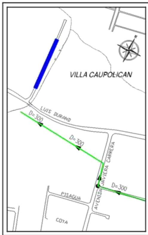
La figura muestra en color azul el segmento con procesos de anegamiento estacional, este último, se solucionaría derivando las aguas lluvias hacia el Estero Coihueco.
